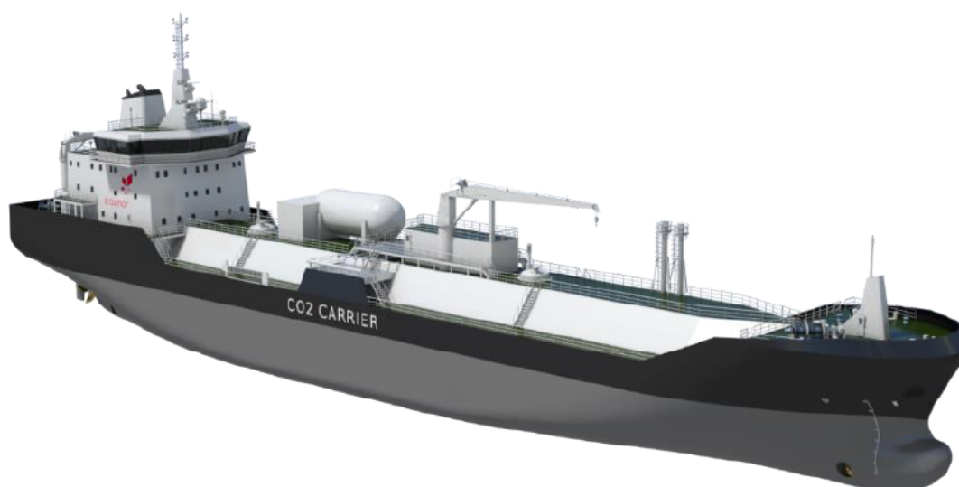
Figur 4-22: Illustrasjon av CO 2 -transportskip med lastekapasitet 7500 m 3 .
