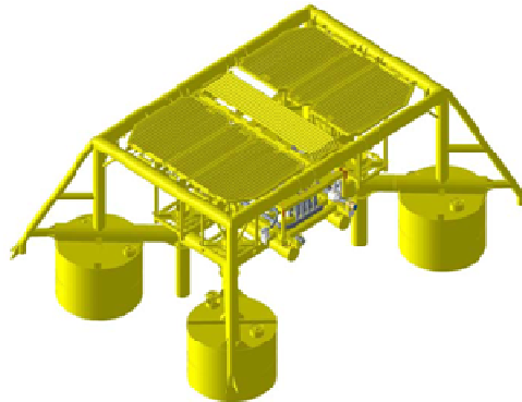
Figur 4.4 - Illustrasjon av havbunnsutstyr (subsea template og manifold) [12]
